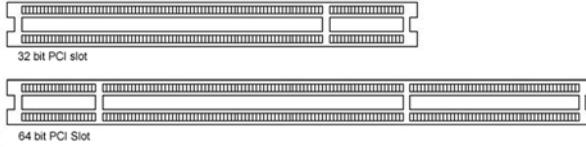
Figura 3: Exemplos de slots PCI
