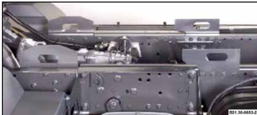
Para fixação do guindaste no quadro do chassi (região do perfil “Z”) será permitida furações de diâmetro, no máximo, de 30 mm para passagem do grampo de fixação, respeitando uma distância mínima de 30 mm das extremidades do perfil “Z” e não atingir o raio de dobra do mesmo.
