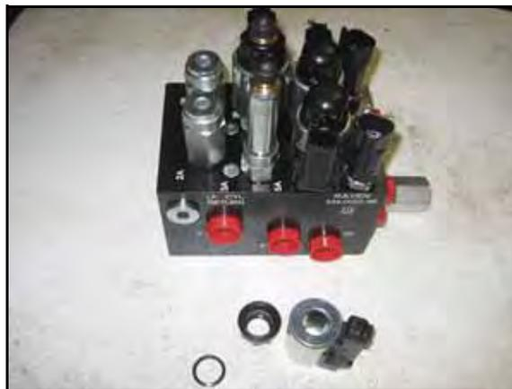
2. Remova as bobinas das solenóides próximas às Portas 3A e 3B para ganhar fácil acesso a tais portas.
