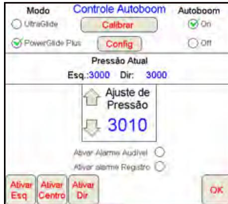
2. Verifique se o AutoBoom está ligado, depois selecione **Ativar Esquerda** ou **Ativar Direita**, ou toque os botões de barra direita e esquerdo para baixo no joystick.
