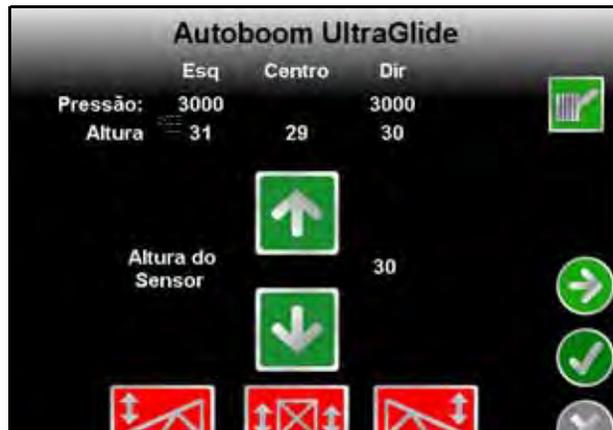
3. Aperte e mantenha pressionado o botão de elevação da barra central no joystick da máquina por seis segundos, de modo que a barra central seja elevado.
