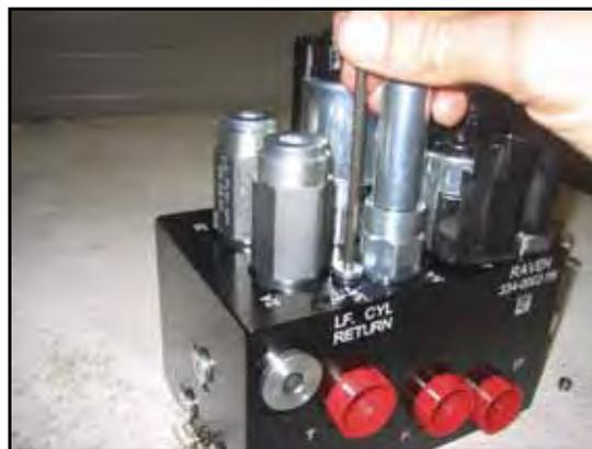
5. Utilize a chave Allen para reinstalar os plugs de porta nas Portas 3A e 3B da válvula AutoBoom.
