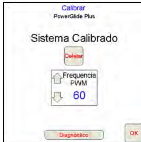
**Observação:** A Frequência PWM exibirá 60 como valor se a válvula AutoBoom tiver bobinas quadradas, e 250 se a válvula tiver bobinas redondas.
