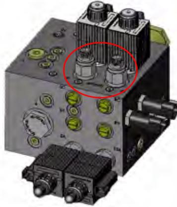
1. Localize as válvulas de agulha nas Portas RT e LF na válvula AutoBoom.
