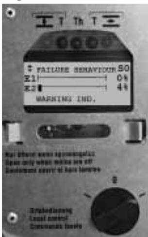
O modo de operação FALHA permite operações de segurança para os casos de ruptura de fiação ou falhas de comunicação .
