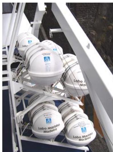
Fig. 13 - Jangadas pneumáticas nos berços
