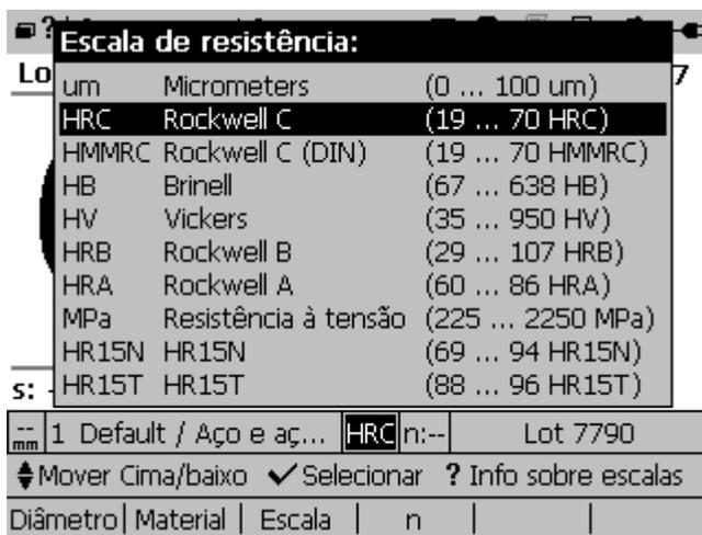
Para alterar a escala de dureza usando funções de conversão de medição de profundidade em  $\mu\text{m}$  para outras escalas:
