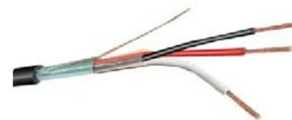
O cabo de comunicação para sistema endereçável é conhecido no meio comercial como cabo para instrumentação. Os cabos de sinais para instrumentação são projetados para transmitir sinais limpos em ambientes industriais e áreas potencialmente perigosas, onde com frequência existe um alto nível de interferências eletromagnéticas e eletrostáticas.
