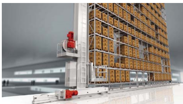
Figura 5. Partilha de energia entre os Variadores de Translação e da Elevação.
