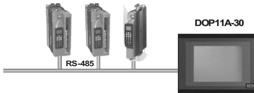
Figura 10: Conexão RS-485
