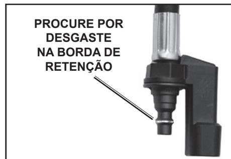
5. Confirme se o mecanismo de desconexão rápida está funcionando corretamente. Os reguladores de respiração equipados com um mecanismo de desconexão rápida usam um acoplamento com engate de puxar para trás. Veja a FIGURA 5. Consulte as instruções e ilustrações a seguir:
