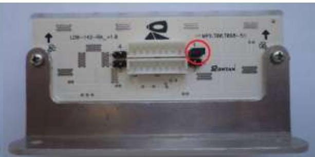
Figura 22 - Jumper na posição 1 (blocos 3, 4, 5, 9, 10 e 11)
