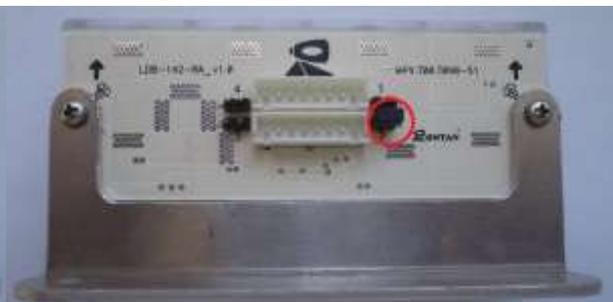
Figura 23 - Jumper na posição 2 (blocos 1, 2 e 6)
