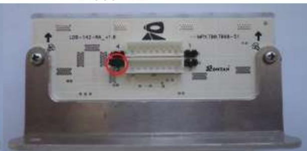
Figura 24 - Jumper na posição 3 (blocos 7 e 14)
