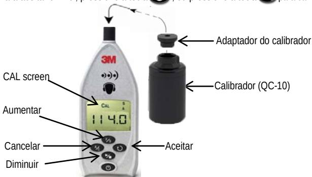
Figura 1-10: Calibração do SD-200
