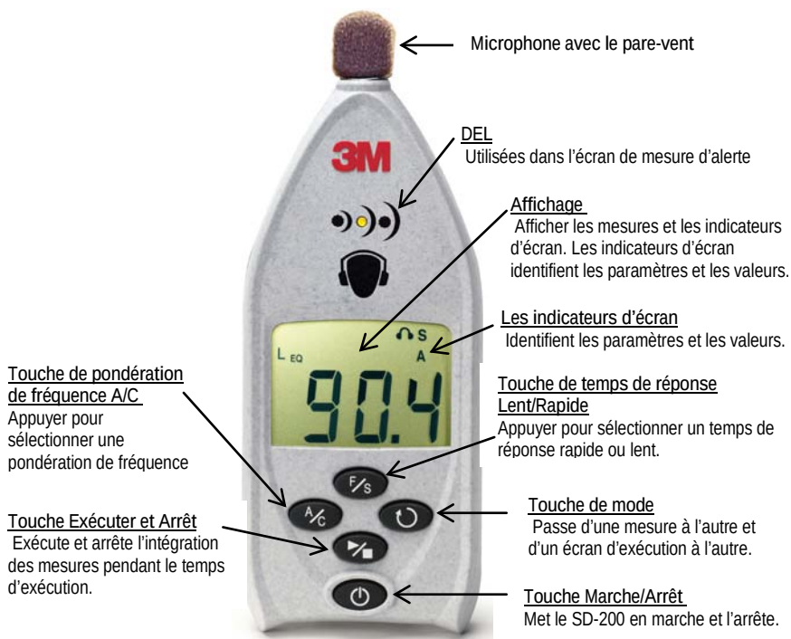
Figure 1-1 : Vue d'ensemble du SD-200
