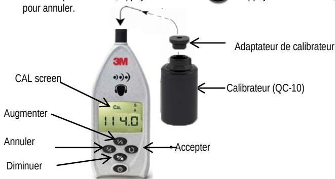
Figure 1-10 : Étalonnage du SD-200
