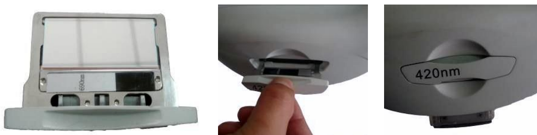
Figura 5.2-1 Inserção do filtro de luz no manípulo (handpiece)
