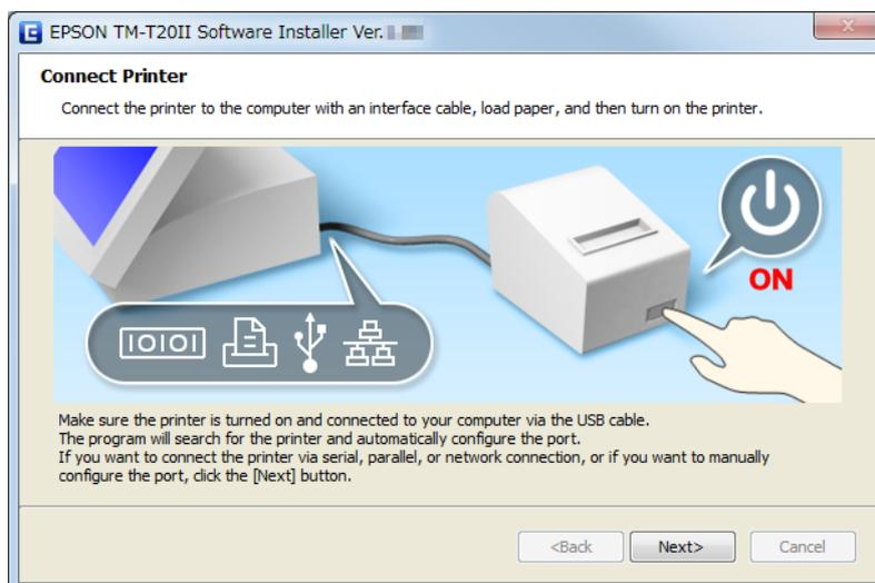
Quando a ligação USB entre o computador e a impressora for estabelecida, é visualizada uma mensagem de pop-up **Installing device driver software (A instalar software de controlador de dispositivo)** na bandeja de tarefas, e a configuração é iniciada automaticamente. Concluída a definição prossiga para a Etapa 10.
