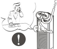
Desligue a alimentação eléctrica quando tiver de fazer qualquer operação de limpeza ou manutenção no aparelho.
