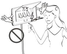
Não coloque um aquecedor ou quaisquer outros equipamentos domésticos junto do cabo de alimentação.
