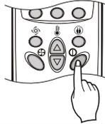
**2** Selecciona Cooling Operation (Operação de Arrefecimento)
