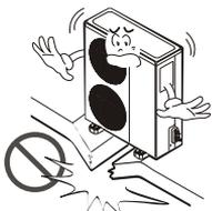
Certifique-se de que o suporte de instalação não se deteriora com o tempo.
