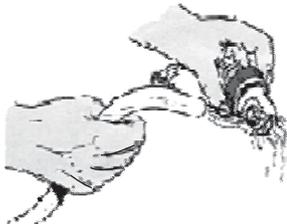
**Use água limpa para lavar qualquer impureza fora da unidade da turbina removível.**
