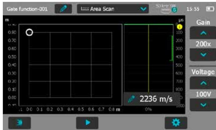
Nos modos de medição de Distância e Velocidade de pulso a função está no alto da tela de medição. No modo de Varredura de área a função está localizada na janela A-Scan do lado direito da tela.
