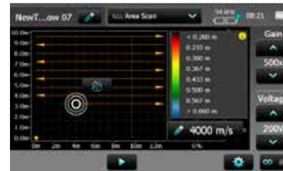
A posição do cursor indica a posição da medição seguinte. Assegure-se de alinhar com uma quadrícula desenhada na estrutura de teste. Você pode puxar o cursor até a posição na quadrícula onde deseja iniciar a medição. Setas indicam a direção de proceder com a medição.
