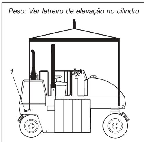
Fig. 27 Cilindro preparado para ser elevado
