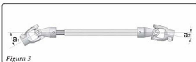
Para a Figura 3 onde os ângulos são diferentes quanto maior a diferença entre eles maior será a irregularidade do movimento rotatório. Essa irregularidade gera ruídos e vibrações que diminuirão a vida útil de seus componentes.
