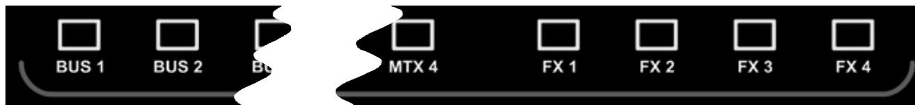
Essas teclas ajustam o console ao modo 'MIX' fornecendo mixagens rápidas e fáceis de Canais a Buses, Canais a FX ou Buses a Matrix. Uma sequência de eventos que reconfigura o sistema de monitoramento da superfície de controle e console para o layout otimizado da função desejada ou requerida, é iniciada ao se pressionar qualquer tecla.
