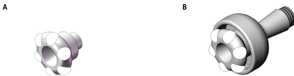
Figura 3. A, adaptador ventosa com esferas; B, adaptador ventosa com esferas conectado no aplicador ventosa.
