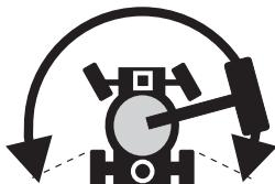
Para acionar, pressione o botão de habilitação de movimento e move lentamente a alavanca de controle de movimento/direção, deslocando-a do centro.
