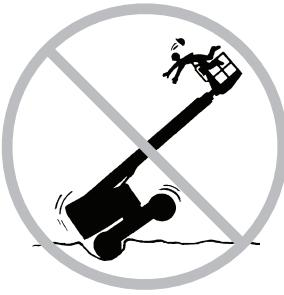
Dirija a máquina na posição retráida, com extremo cuidado e em baixa velocidade, ao passar por terrenos irregulares, detritos, superfícies instáveis ou escorregadias e próximo a buracos e declives acentuados.
