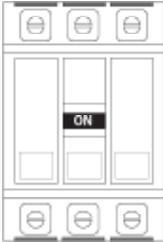
**DISJUNTOR** – Sua finalidade é proteger o motor contra queima além de servir como uma chave geral do elevador. Recomendamos o uso de um disjuntor por elevador. Especificação do disjuntor termo magnético conforme modelo de seu elevador.
