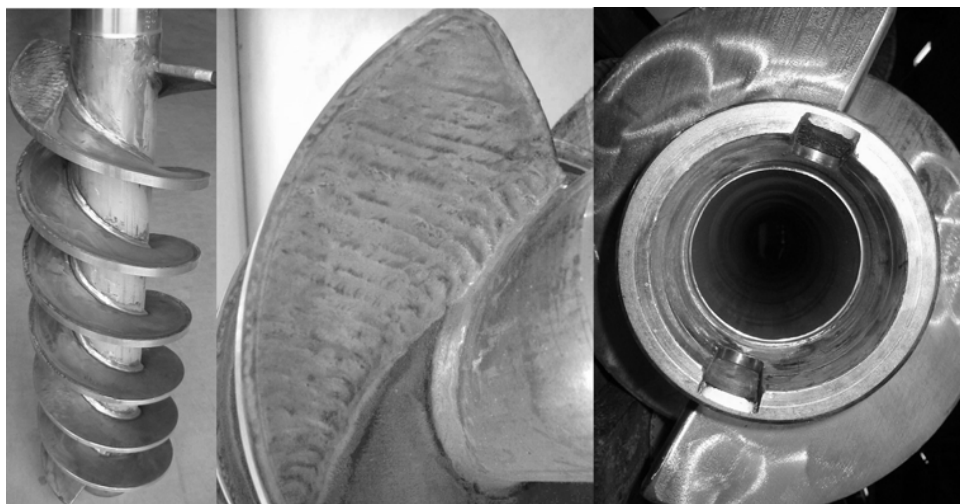
Imagem 4.9: Eixo sem-fim com helicoides reforçadas e alojamento, perfeito estado.
