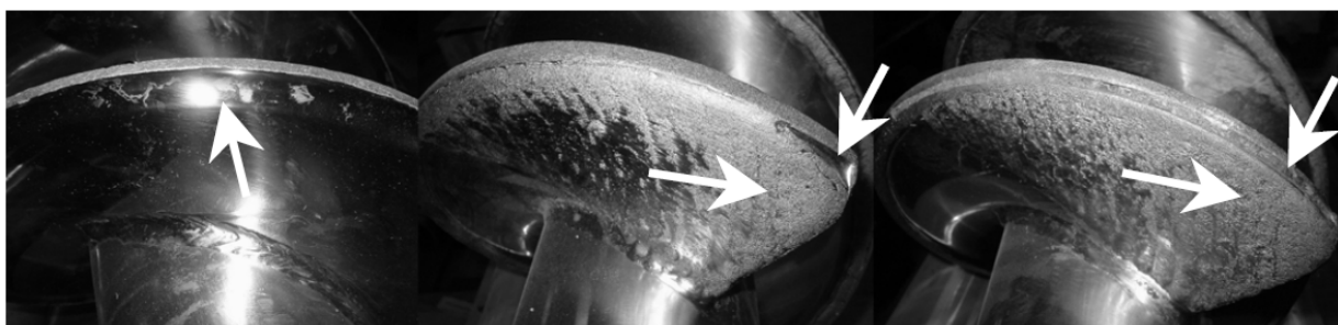
Imagem 4.13: Indicações para a necessidade de conserto do eixo sem-fim
