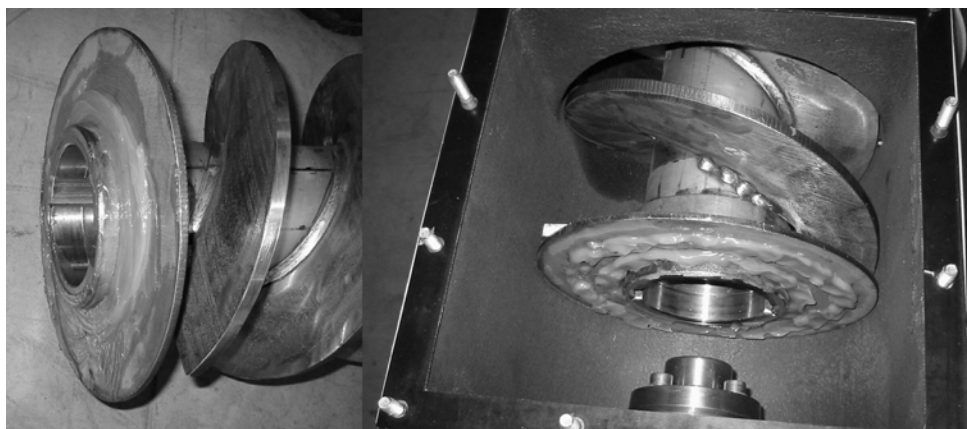
Imagem 4.10: Eixo sem-fim com placa motora e proteção adicional ao motor de engrenagem.
