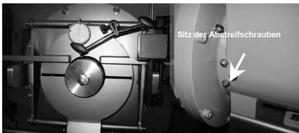
Imagem 4.11: Controle do movimento radial do eixo sem-fim (lado esquerdo) dos parafusos de ajuste(lado direito).
