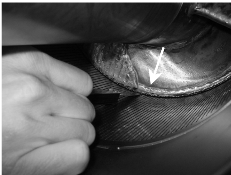
Imagem 4.12: Medição de espaço radial entre a peneira e o eixo sem-fim
