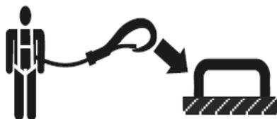
• Antes da operação, verificar se todas as cancelas e corrimões se encontram trancados na posição de segurança. Identificar o(s) ponto(s) de fixação adequado(s) na plataforma e fixar bem o cabo de segurança. Fixar apenas um (1) cabo de segurança a cada ponto de fixação.
