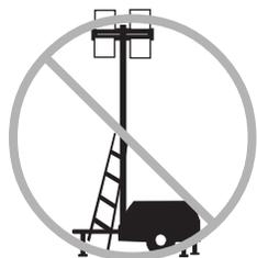
Não coloque escadas ou andaimes apoiados em qualquer parte da máquina.
