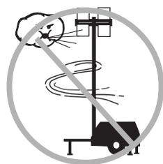
Não eleve a torre quando a velocidade do vento for superior a 100 km/h.
