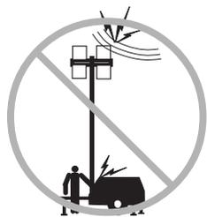
Mantenha-se afastado da máquina em caso de contato com linhas de transmissão energizadas. Não toque na máquina nem a coloque em funcionamento até que as linhas de transmissão sejam desligadas.
