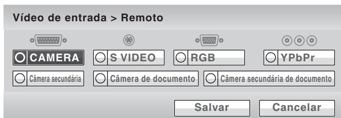
Use a tecla **↑**, **↓**, **←** ou **→** no Controle Remoto para selecionar a saída de imagem do equipamento conectado ao sistema remoto e pressione a tecla ENTER. A imagem selecionada é inserida no sistema local e exibida na tela do monitor.
