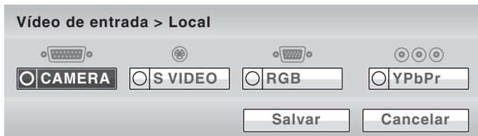
Use a tecla **↑**, **↓**, **←** ou **→** no Controle Remoto para selecionar o equipamento externo conectado a cada entrada de vídeo no Sistema de Comunicação e pressione a tecla ENTER.
