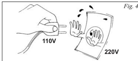
É importante verificar a voltagem nominal da rede de energia do local em que o equipamento vai ser instalado. A central sai ajustada da fábrica para operar em 220V de alimentação. Se a tensão da rede de energia elétrica da sua cidade for de 110V, ajuste o seletor de tensão para o valor correto.
