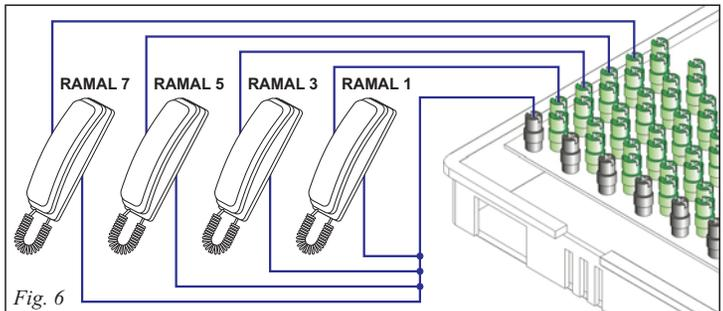
Para tanto deve-se abrir o interfone e aparafusar o fio na placa de circuito impresso interna. A outra extremidade do fio é conectada na base dos ramais. Por exemplo, para ligação do fio do primeiro apartamento, uma ponta é presa no conector número 1 e a outra no conector GND da base dos ramais (não há polaridade na ligação).
