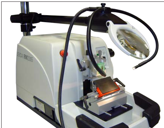
Fig. 62, Micrótopo giratório Leica com os acessórios opcionais instalados: lente de aumento e guia luminosa de fibra óptica
