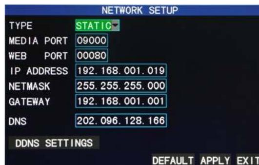
**Modo de conexão:** com 3 opções: configuração estática, DHCP e PPPoE
