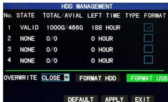
**Estado do Disco Rígido:** Após o disco rígido ser ligado, o sistema vai detectar o disco rígido e corrigir automaticamente. Se o disco rígido precisar de formatação, irá aparecer uma mensagem "Não formatado" e para formatar basta clicar em "HDD Format". Se o sistema detectar um disco rígido disponível, o estado do disco rígido será "Normal";
