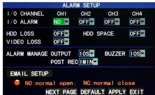
**Estado de alarme:** Cada canal corresponde a um (I / O) estado de alarme, ou seja, quando a entrada de alarme de um canal for válido, o registro do alarme do canal correspondente será iniciada.
