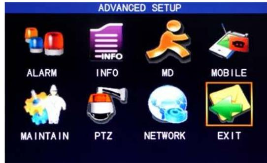
As funções avançadas incluem as sete opções de configuração de alarme, sistema de informação, detecção de movimento, o acompanhamento do telefone móvel, a manutenção do sistema, instalação, controlo PTZ e Configuração de Rede.
