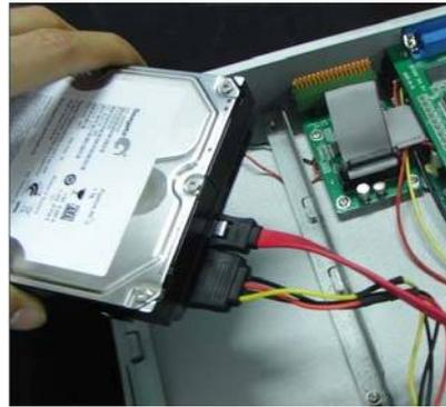
C Coloque o disco rígido no suporte, e alinhar o buraco do parafuso do disco rígido com o apoio.
