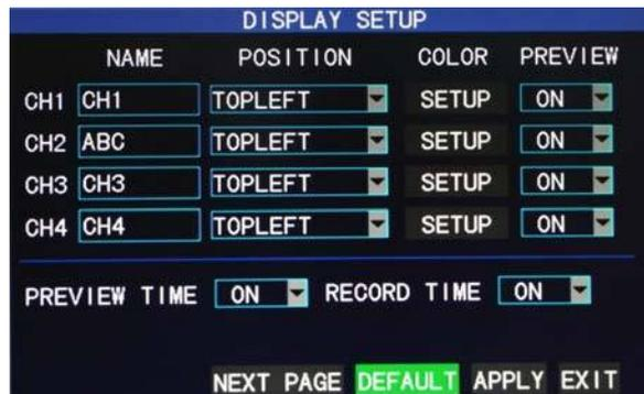
**Nome do Canal:** Mova o cursor para a caixa de entrada desta opção e pressione "Enter" para entrar na tela de entrada desta opção. Os métodos numéricos, Inglês e Chinês de entrada de pinyin são suportados;
