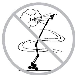
Não opere a máquina se houver ventos fortes ou rajadas de vento. Não aumente a área da superfície da plataforma ou da carga. O aumento da área exposta ao vento reduz a estabilidade da máquina.
