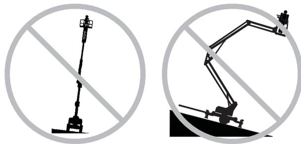
Não monte a máquina sobre uma superfície onde não possa ser nivelada somente com os estabilizadores.
