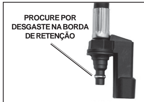
FIGURA 6 Inspeção de engates de desconexão rápida machos
