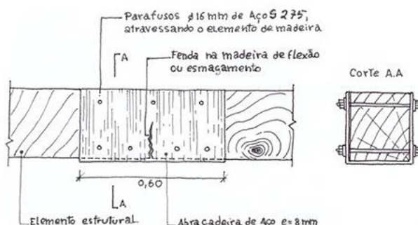
Detalhe de braçadeira metálica para reforço no vigamento
