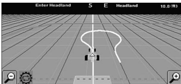
*Curva Lâmpada Simétrica (Ponto de Controle 0 m [0 ft] ou usando o engate de 3 pontos) (O raio de Giro é maior que a metade do Espaçamento entre Pistas).*
