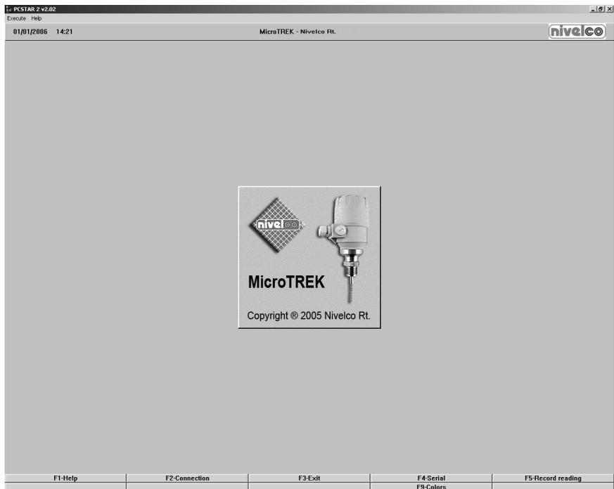
**Definição da interface do dispositivo:** pressione F4 ou clique com botão esquerdo em "F4-Serial" no fundo da tela – para definir qual interface estará conectada.
