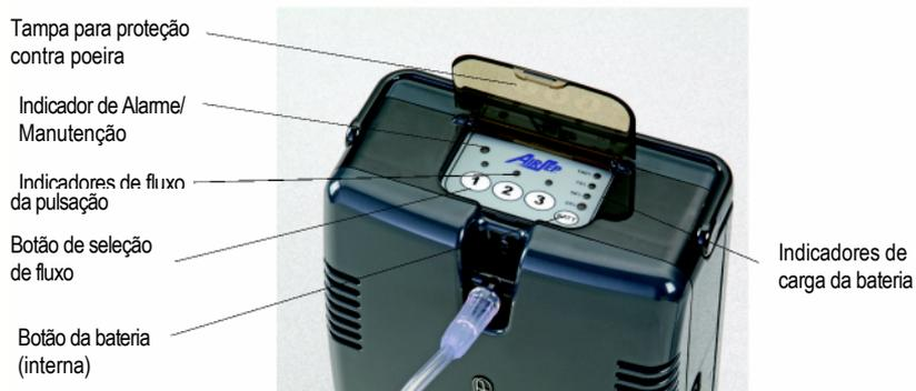
Figura 9: Destaque do Teclado/Visor de alarme
