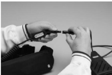
**Figura 6: Carregamento da bateria do AirBelt**
