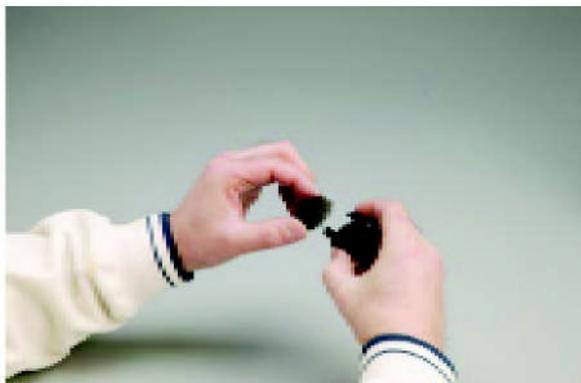
**Figura 12: Remoção do filtro da tampa do filtro**
