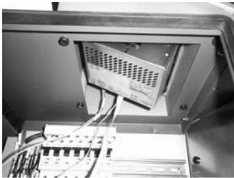
1. Levante um pouco o painel de comando de um dos lados e introduzir um clipe (veja as setas) do lado oposto. Depois disso, é possível retirar o painel de comando para fora do recorte, de modo que as ligações fiquem a descoberto.
