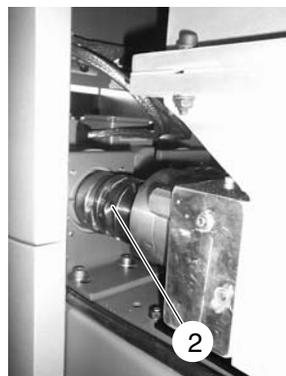
**CUIDADO:** O motor está exactamente alinhado e não pode ser deslocado para trás no orifício oblongo conjuntamente com a cantoneira. Se isto for inevitável, consulte *Substituição do motor / Alinhamento do motor*.
