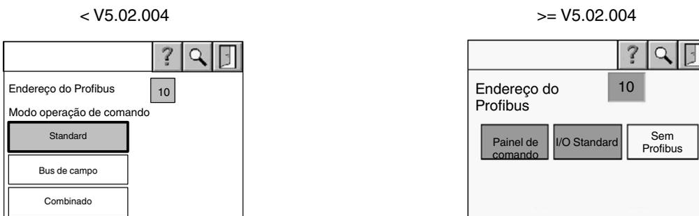
Fig. 4-18 Exemplo de opção Profibus, modo de operação de comando *Standard* seleccionado
