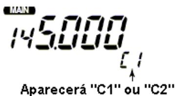
Pressione [M/CAL • MW] várias vezes para selecionar o modo de canal de chamada, e depois gire o [DIAL] da mesma banda para selecionar o canal de chamada desejado.
