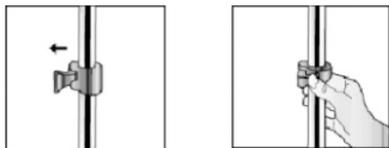
**4** - Levantar os dois braços do cabide ao nível horizontal, eles deverão ficar travados automaticamente. Para liberar os braços, basta pressionar os dois botões existentes no cabide
