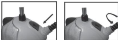
**2** - Encaixe a haste retrátil na base da haste, girar a rosca da base da haste no sentido horário até a haste retrátil ficar firmemente travada.
