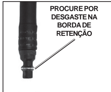
FIGURA 5 Inspeção de engates de desconexão rápida machos
