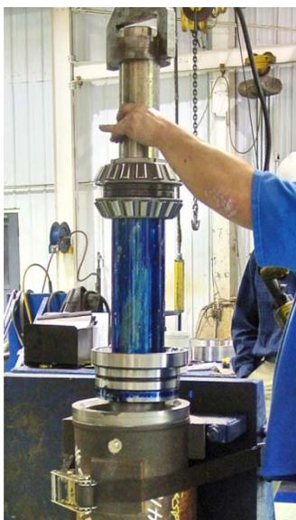
Montagem do mancal inserido na extremidade de acionamento do alojamento
