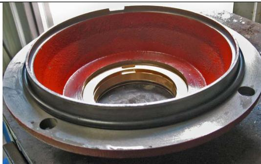
Instale com retorno de lubrificação na posição 6 horas
