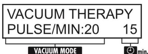
Pressione agora a tecla START para início e execução da programação que foi feita. Note que o cursor "piscante" desaparece e a bomba de vácuo é acionada. Gire o controle ajuste de intensidade de vácuo (7) até que o indicador da quantidade de vácuo mostre aproximadamente -250 mmHg. Ao final do tempo programado, a bomba de vácuo será desligada e um alarme sonoro indicará final de tratamento.
