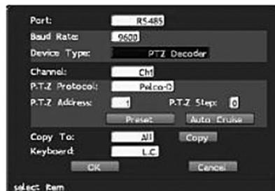
Configure o número do canal do decodificador, incluindo velocidade, bit de dados, bit de parada, caixa e controle de fluxo, no menu da porta serial do aparelho. Os valores desses itens devem coincidir com o aparelho ligado em série. Os valores padrão são: 8 bits de dados, 1 bit de parada, nenhum bit de verificação e nenhum controle de fluxo de hardware. Estes dados não podem ser revistos pelo cliente.
