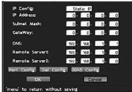
**Configuração de IP:** Os modos disponíveis para obter IP são: Automático e Estático. O protocolo DHCP é usado para obter o IP automaticamente. A LAN deve possuir um servidor DHCP, caso contrário o gravador não poderá obter um IP.
