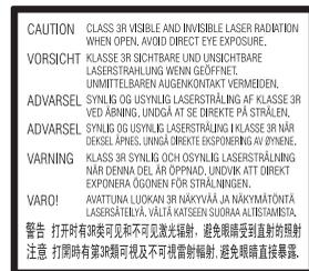
Este aparelho está classificado como um produto CLASS 3R LASER (laser da classe 3R). As radiações laser visíveis ou invisíveis são emitidas quando a caixa de proteção do laser é aberta, por isso, evite a exposição direta dos olhos à radiação. Esta indicação está localizada na caixa de proteção do laser localizada no interior do aparelho.
