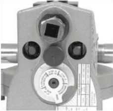
Figura 10A – Coloque o passo correto do medidor sob a cabeça do parafuso de ajuste
