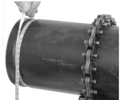
Figura 16 – Verificação do diâmetro da ranhura com uma fita métrica.
