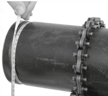
Figura 11 – Verificação do diâmetro da ranhura com uma fita métrica.
