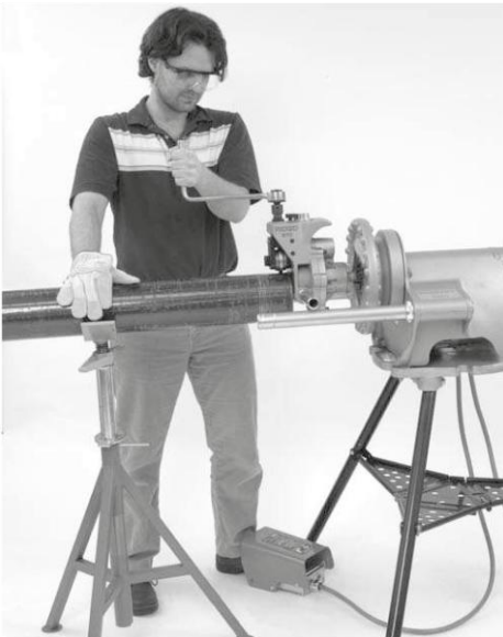
Figura 13 – Aplicação de força sobre o tubo ao ranhurar para manter o curso
