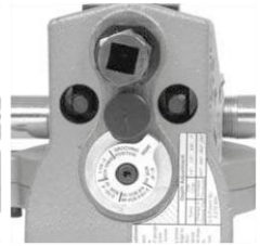
Figura 15B – Medidor na posição de abertura de ranhura
