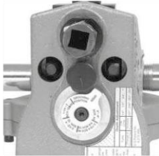
Figura 10B – Medidor na posição de abertura de ranhura
