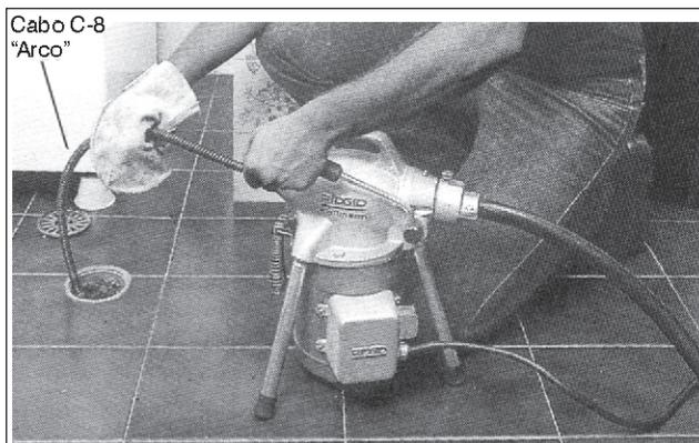
Forme um arco conforme a ilustração acione o cabo da embreagem (sentido horário) após introduzido o cabo, repita a operação.
