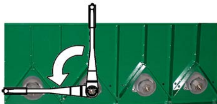
3 - Gire a Ramp-Lok 2 mais 90° no sentido anti horário para a posição de 180°
