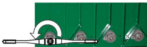
2 - Gire a Ramp-Lok 1 no sentido anti horário para a posição de 180°
