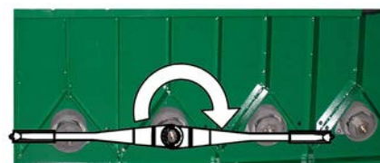
2 - Gire a Ramp-Lok 2 no sentido anti horário para a posição de 180°
