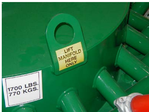
Figura 3-5 Instalação dos suportes de envio e pontos de elevação do dessiltador
