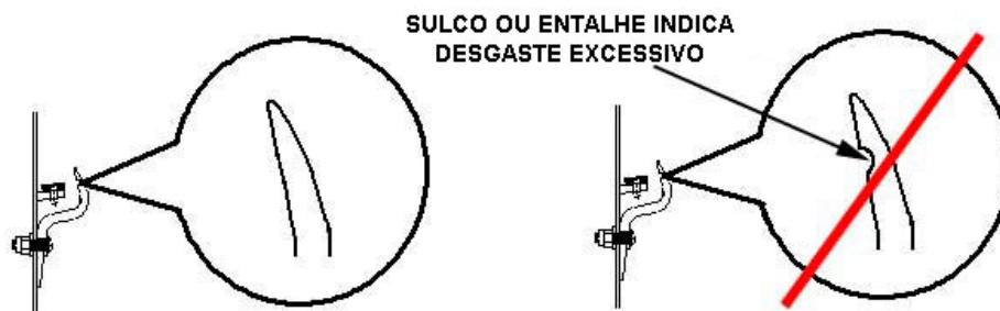
Figura 6-4 Amostra do desgaste do dedo devido ao tencionamento insuficiente do painel de tela
