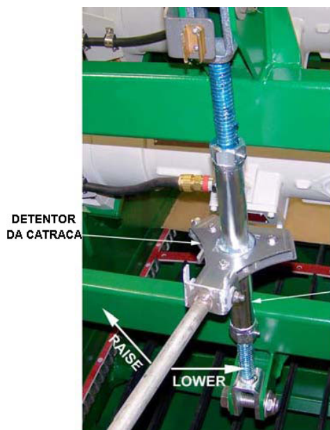
Figura 4-5 Ajuste AWD do parafuso jack manual
