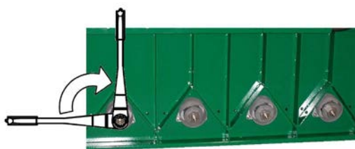
1 - Gire a Ramp-Lok 1 no sentido anti horário para a posição de 90°
