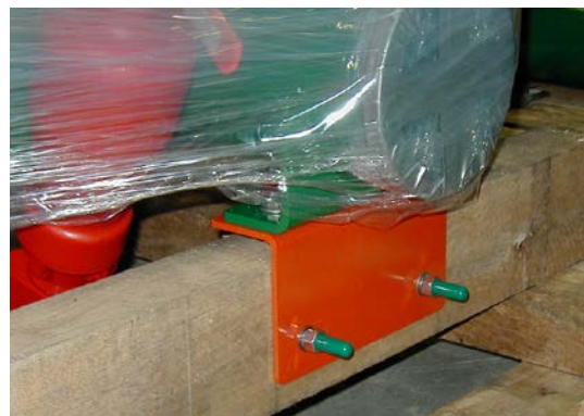
Figura 3-5 Instalação dos suportes de envio e pontos de elevação do dessiltador
