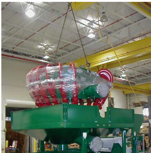
Figura 3-6 Abaixando o dessiltador no recipiente coletor
