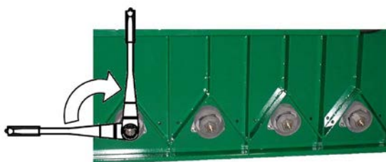
1 - Gire a Ramp-Lok 1 no sentido horário para a posição de 90°
