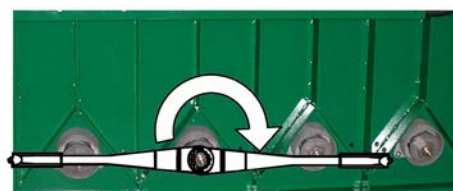
2 - Gire a Ramp-Lok 2 no sentido horário para a posição de 180°
