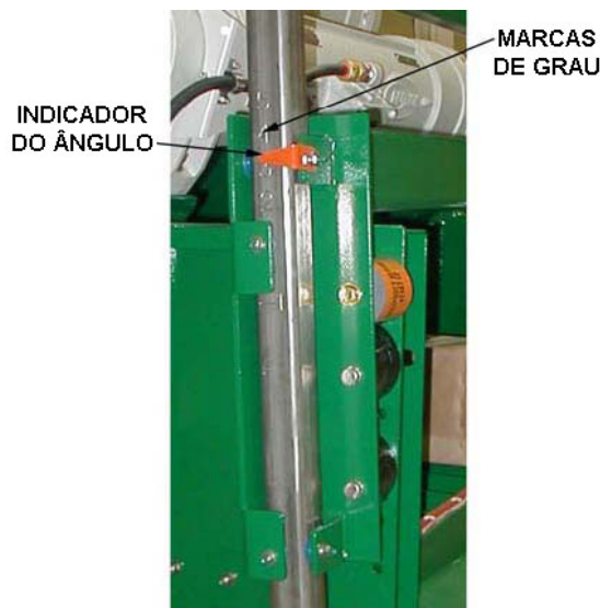
Figura 4-5 Ajuste AWD do parafuso jack manual
