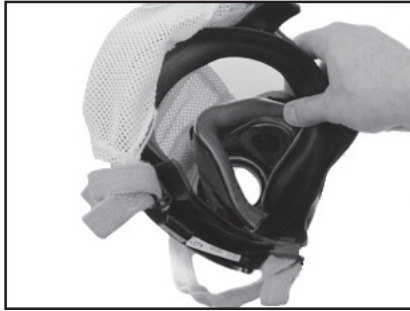
FIGURA 3 Verificação dos dutos do diafragma de voz
