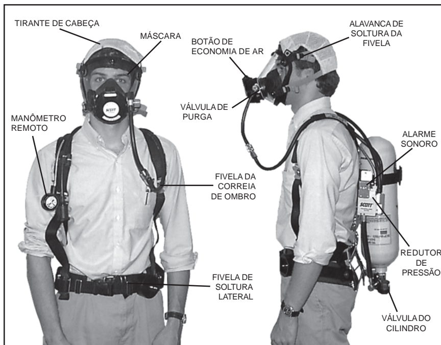
SCBA INDUSTRIAL TÍPICO (MODELO DE 4500 PSI MOSTRADO) FIGURA 1
