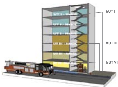
FIGURA 2: Altura da utilização-tipo
