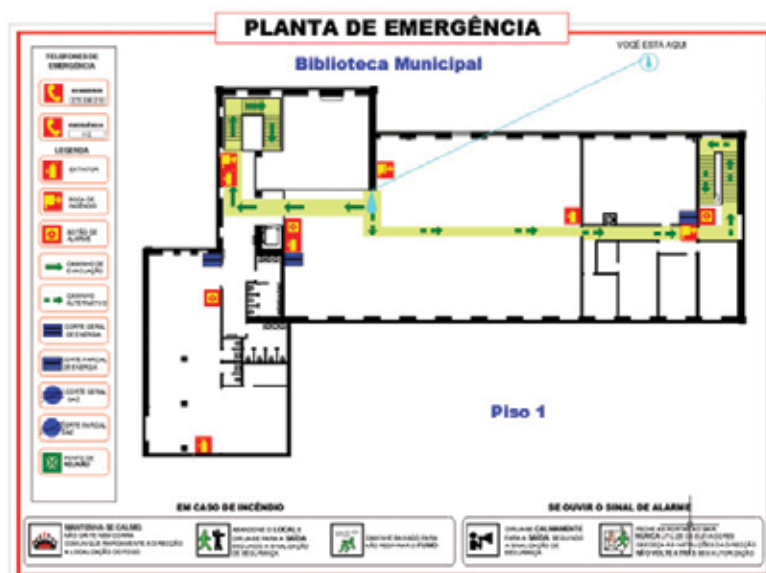
FIGURA 17 Planta de emergência
