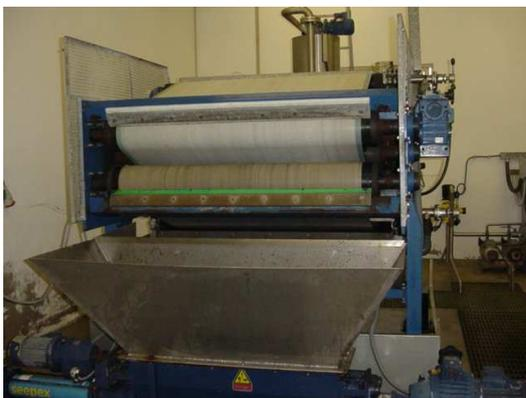
**Fig. 6** – Filtro de banda da ETL. [16]
