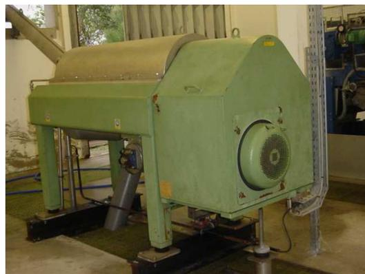
**Fig. 7** – Centrífuga da ETL. [16]
